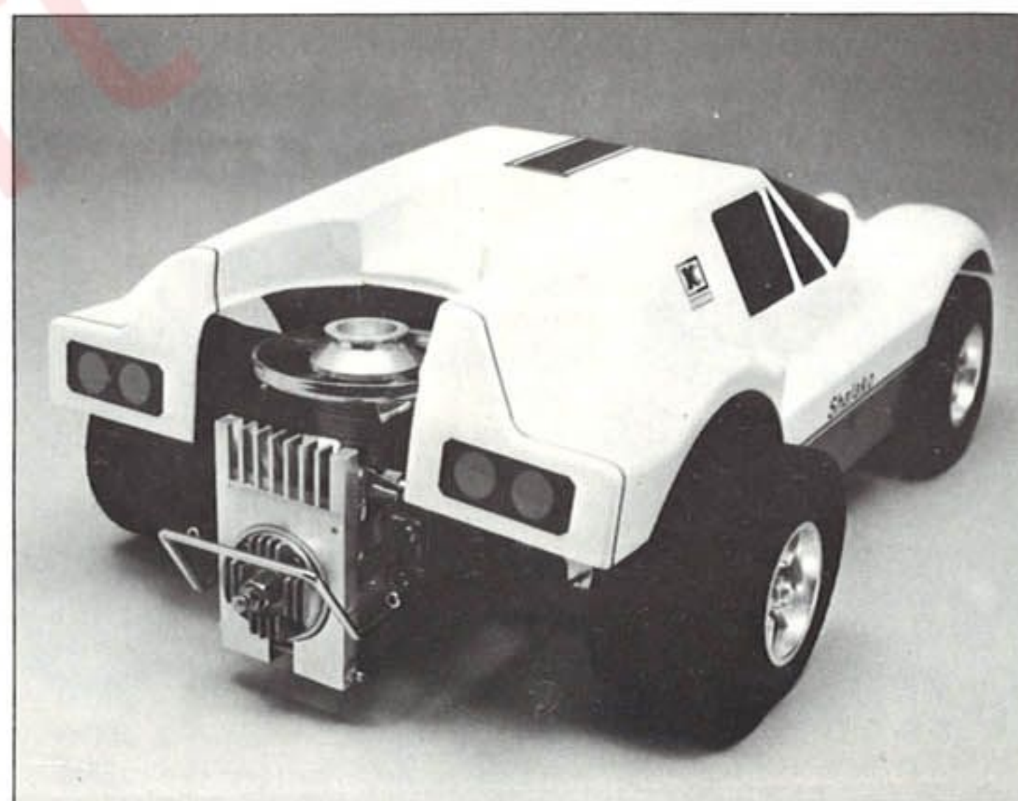
空冷ファンとアルミヒートシンクがついて高速回転エンジンもOK
