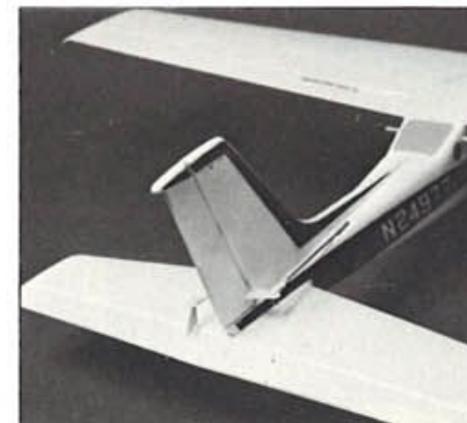
ラダー・エレベーター・ロッドホーンなどすべて取り付け完成品
